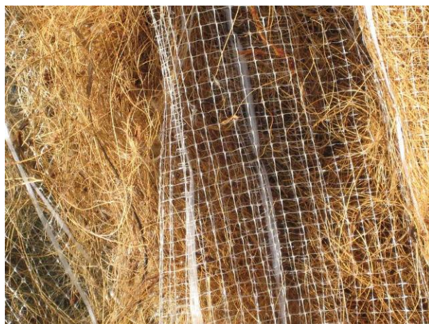
Foto 227 Reticelle di supporto a maglia troppo fitta impediscono lo sviluppo delle piante
