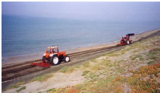
Foto 167 L'erpatura di pulizia delle spiagge a fini balneari danneggia la stabilità della sabbia (foto G. Sauli )
