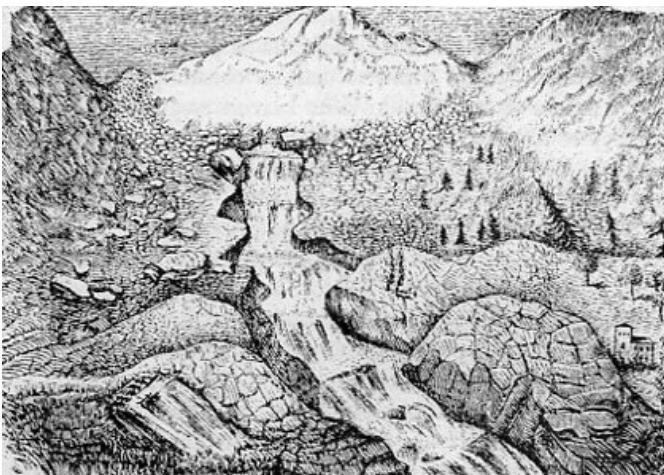
Fig. 6 Schema di sistemazione di un torrente con gabbioni metallici cilindrici impilabili, accostati e resi solidali con legature in fil di ferro, disposti trasversalmente al corso d'acqua (da Serrazanetti, 1898)
