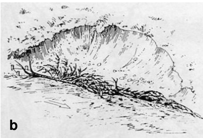
Fig. 8 Schema di difesa spondale radente realizzata mediante albero intero disposto orizzontalmente. In a da Piccioli (1905) in b da Patt et al. (1998).
