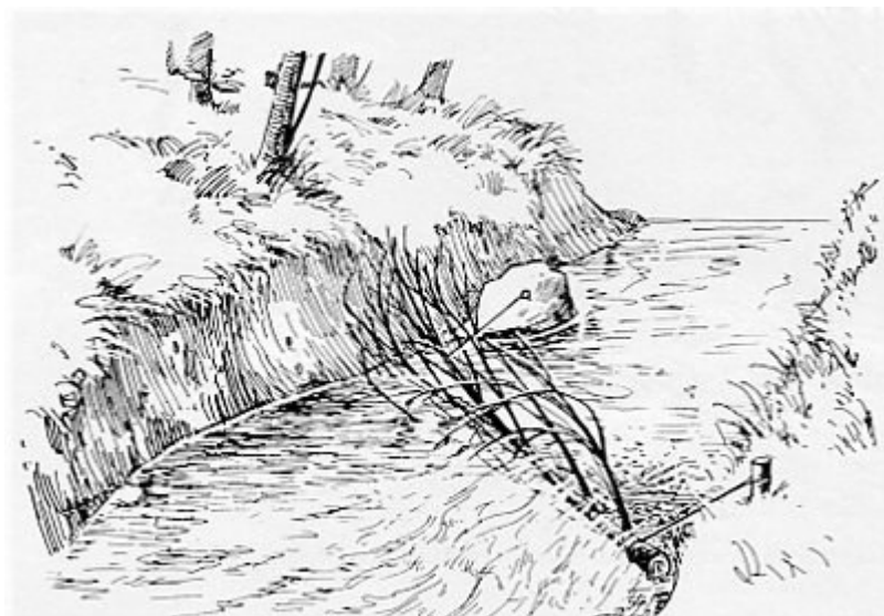
Fig. 10 Schema di soglia realizzata mediante albero intero (da Patt et al, 1998)
